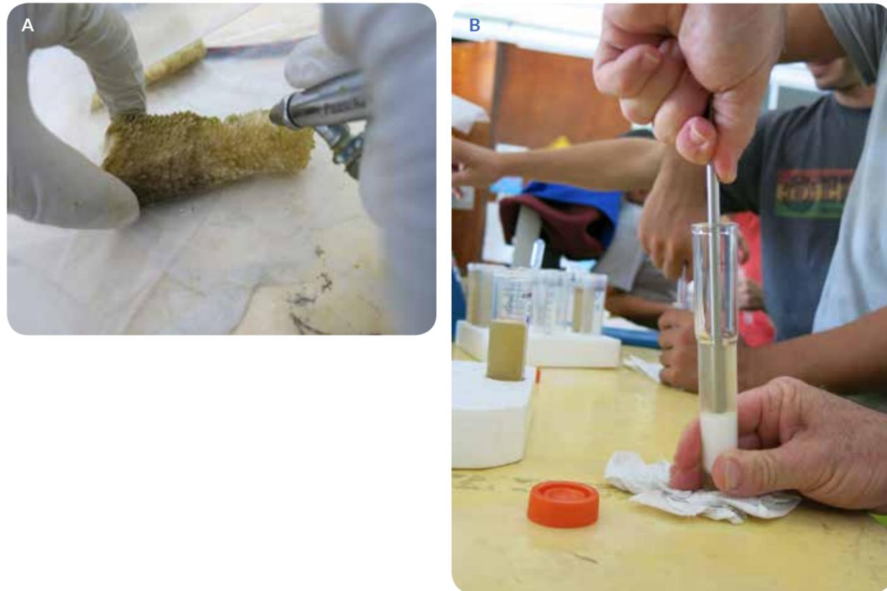
Una vez homogeneizado, el extracto se transfiere a tubos Falcon de 50 ml y se centrifuga a 5000 rpm/ 5 min, el sobrenadante se desecha y el pellet se lava con 30 ml de agua de mar filtrada (1  $\mu$ m) utilizando un vortex. El pellet se disuelve en el agua de mar filtrada. El lavado del pellet se repite 3 veces.
